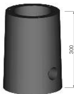
FUNDAMENT BETONOWY B-0
